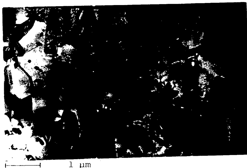
FIGURA 6.- Microestrutura de amostra não irradiada, deformada com 200 MPa a 700°C.
